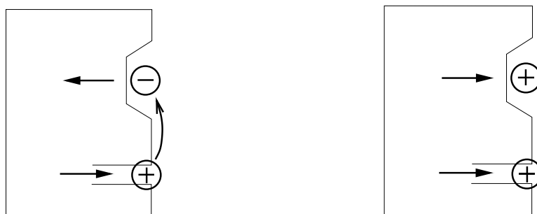
Rayonnement en mode incompressible Rayonnement en mode compressible Court circuit acoustique Monopole
